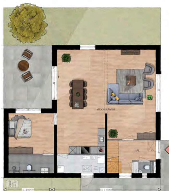
Uitbreiding aan de achterzijde voor een slaapkamer en een badkamer.
