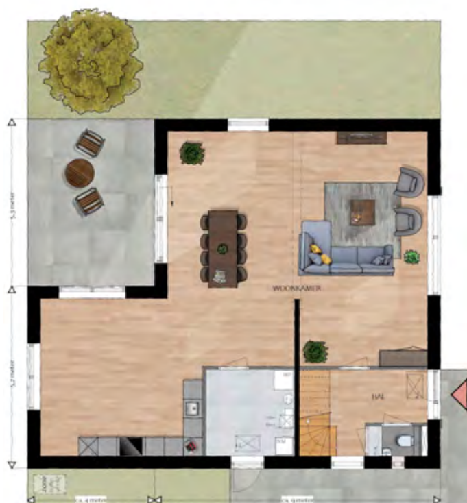
Uitbreiding aan de achterzijde t.b.v. de keukenopstelling.
