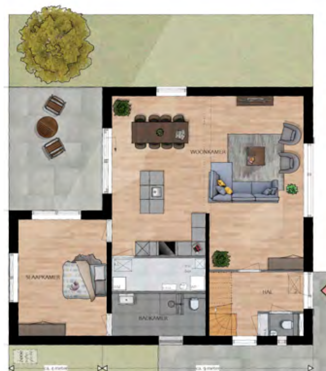
Uitbreiding aan de achterzijde voor een grote slaapkamer met een badkamer.
